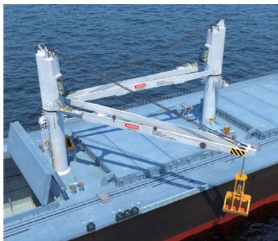
船上デッキの荷役作業用クレーンで旋回・昇降・俯仰の3軸を制御します。
